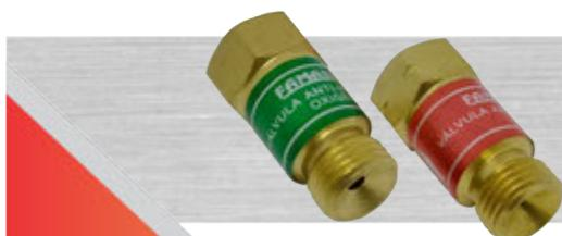
Sistema de segurança utilizado nas entradas do maçarico de corte e maçarico de solda. Construído em latão, possui sistema interno tipo retenção, bloqueando o retorno do fluxo. É vendido em conjunto, uma válvula anti retrocesso para o oxigênio e outra para gases combustíveis.
