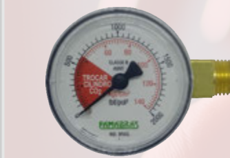
MANÔMETRO Ø52mm CAIXA EM AÇO CARBONO 140 KGF/CM 2 X 2000 LBF/POL 2
