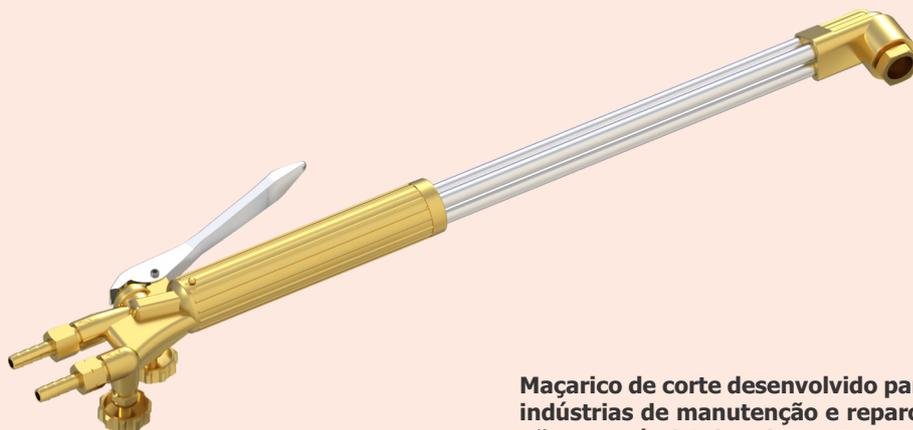
Maçarico de corte desenvolvido para operações moderadas, utilizado em indústrias de manutenção e reparos, possui sistema tipo injetor interno não removível, tubos de Aço Inox, cabeça 90°, opera com bicos de corte nº 1502 para acetileno e 1503 para GLP.
